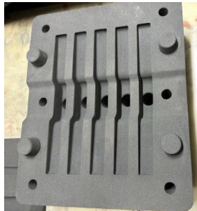
Şekil2. 3D Baskılı Kum Kalıba Alçak Basınçlı Döküm
