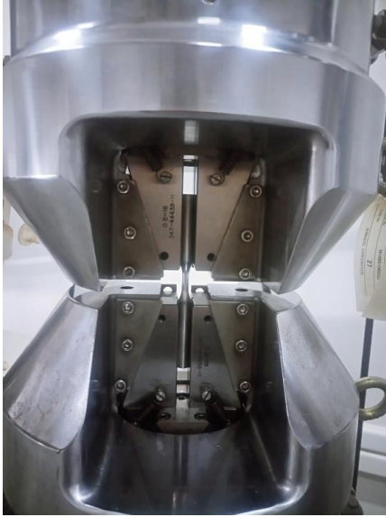
Şekil 4. Yorulma test konfigürasyonu ve cihaza yerleştirilmiş numune görüntüsü.
