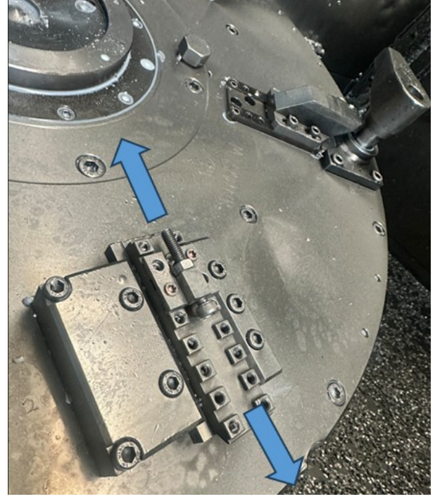
Şekil 2. Mevcut ayna merkezleme sistemi
